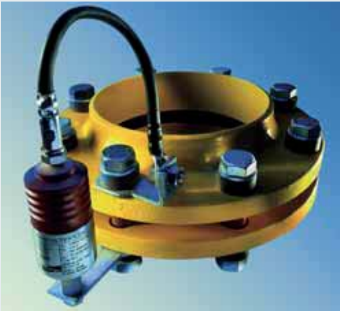
Vía de chispas de separación homologada por ATEX para la compensación de potencial de protección contra el rayo según DIN V VDE V 0185 con baja tensión de respuesta.
